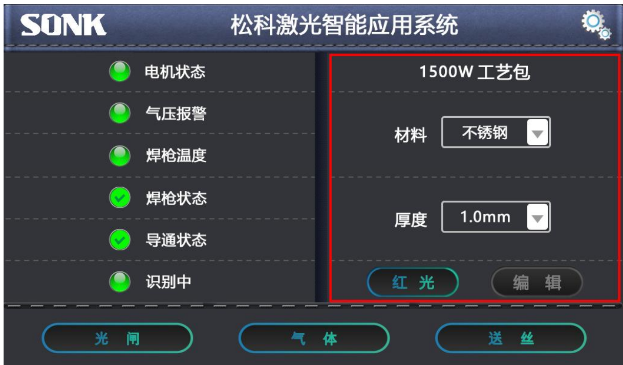
工艺包参数界面（点编辑可进激光器控制和焊接控制）
